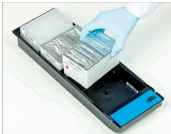
▲ 図3：ラックに試薬トレイをセットする
