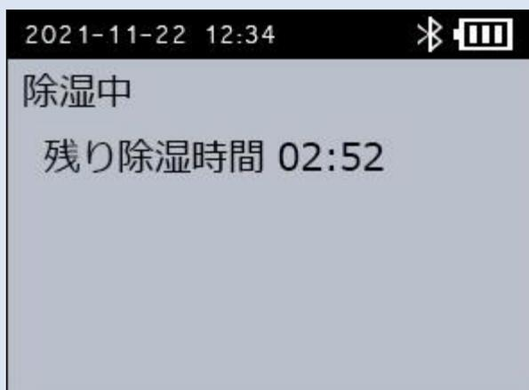
[除湿中]画面の[残り除湿時間]が経過すると [測定] 画面が表示され、測定が開始されます。
